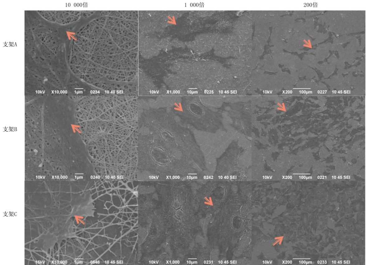
图 3 三种支架的 SEM 图像(箭头处为细胞)
